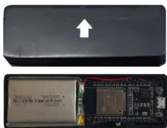
Figura 8. Prototipo IoT para prevenir úlceras por presión
